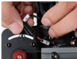
X(2PIN)-axis Endstop Switch Cable
