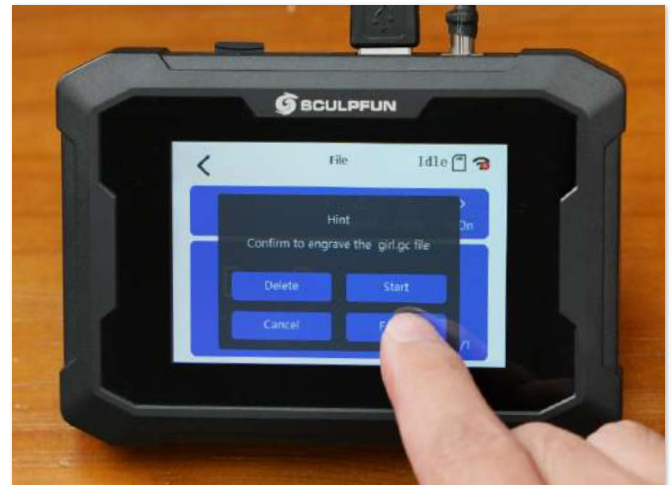
10. Wählen Sie die Datei aus, die graviert werden soll, und klicken Sie auf „Edge Patrol“, um sicherzustellen, dass der Gravurbereich innerhalb des geeigneten Bereichs liegt.Standort
