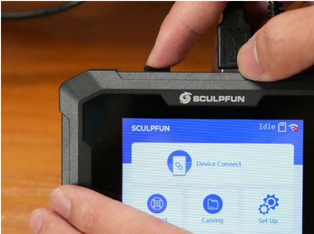
7. Entfernen Sie die SD-Karte und stecken Sie sie in TS1 ein
