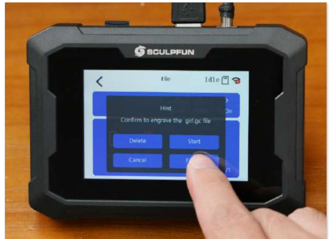
10. Selezionare il file da incidere e fare clic su Edge Patrol per assicurarsi che l'intervallo di incisione sia nella posizione appropriata.
