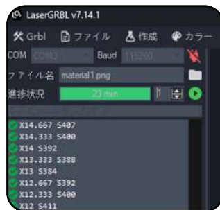
図18 彫刻/切断の開始
