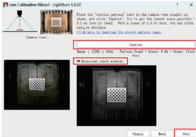
⑤ Kalibrieren Sie jede Position in der vorgegebenen Reihenfolge gemäß den Anweisungen der Software, bis die Kamerakalibrierung abgeschlossen ist, und klicken Sie dann auf "Finish".
