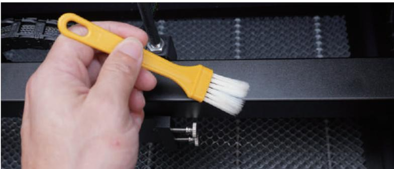
9.3.2 Entfernen Sie die Schublade, leeren Sie alle Abfälle und Staub aus und wischen Sie sie mit einem fusselfreien Tuch sauber. Setzen Sie dann die Schublade wieder in die Maschine ein. Das untenstehende Bild zeigt die abgeschlossene Reinigung.
