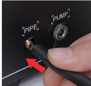
Schritt 2: Verbinden Sie das große Luftrohr zwischen der Luftpumpe und der Maschine.
