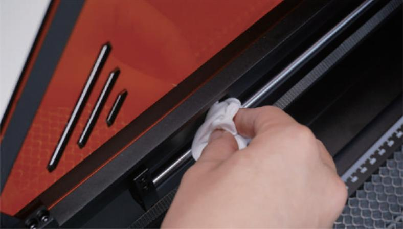
9.2.2 Nehmen Sie das Schmiermittel heraus, drücken Sie eine kleine Menge heraus und tragen Sie es auf die optischen Schienen auf. Bewegen Sie die Y-Achse manuell, um das Schmiermittel gleichmäßig entlang der Schienen zu verteilen.
