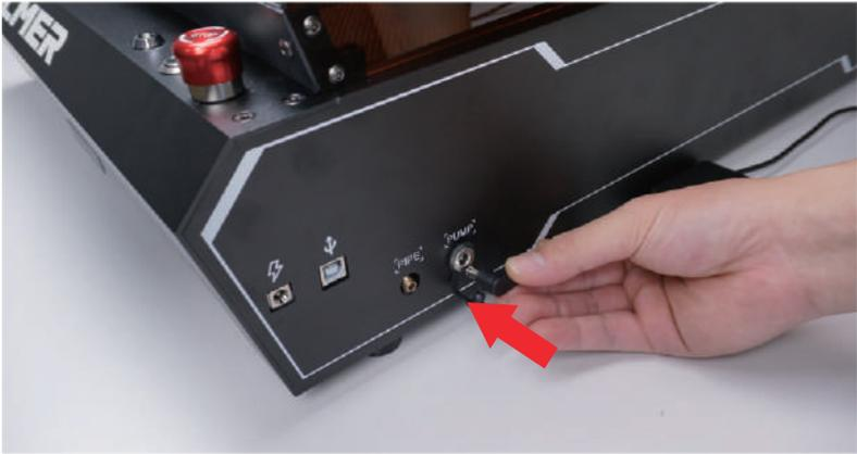
Schritt 1: Schließen Sie das Netzkabel der Luftpumpe an.
