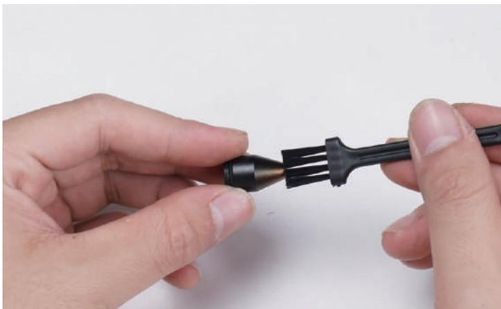
9.1.4 Wenn sich viel Staub auf dem Laserkühlhüfiter befindet, verwenden Sie die gelbe Borstenbürste, um den Staub zu entfernen.
