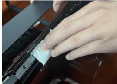
9.2.4 Drücken Sie eine kleine Menge Schmiermittel heraus und tragen Sie es auf die Führungsschiene auf. Drehen Sie die Maschine wieder um, sodass die Oberseite nach oben zeigt, und bewegen Sie die X-Achse manuell, um das Schmiermittel gleichmäßig entlang der Schiene zu verteilen.
