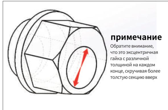
Remarque: Avant de positionner l'ensemble de l'axe X vers le profil de l'axe Y, vous devez ajuster l'excentrique pour augmenter l'espace des poulies des deux côtés, afin de ne pas endommager les poulies en raison de l'espace des poulies trop proche lors de l'installation.
