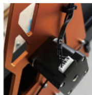
6 Cable del motor Y2
